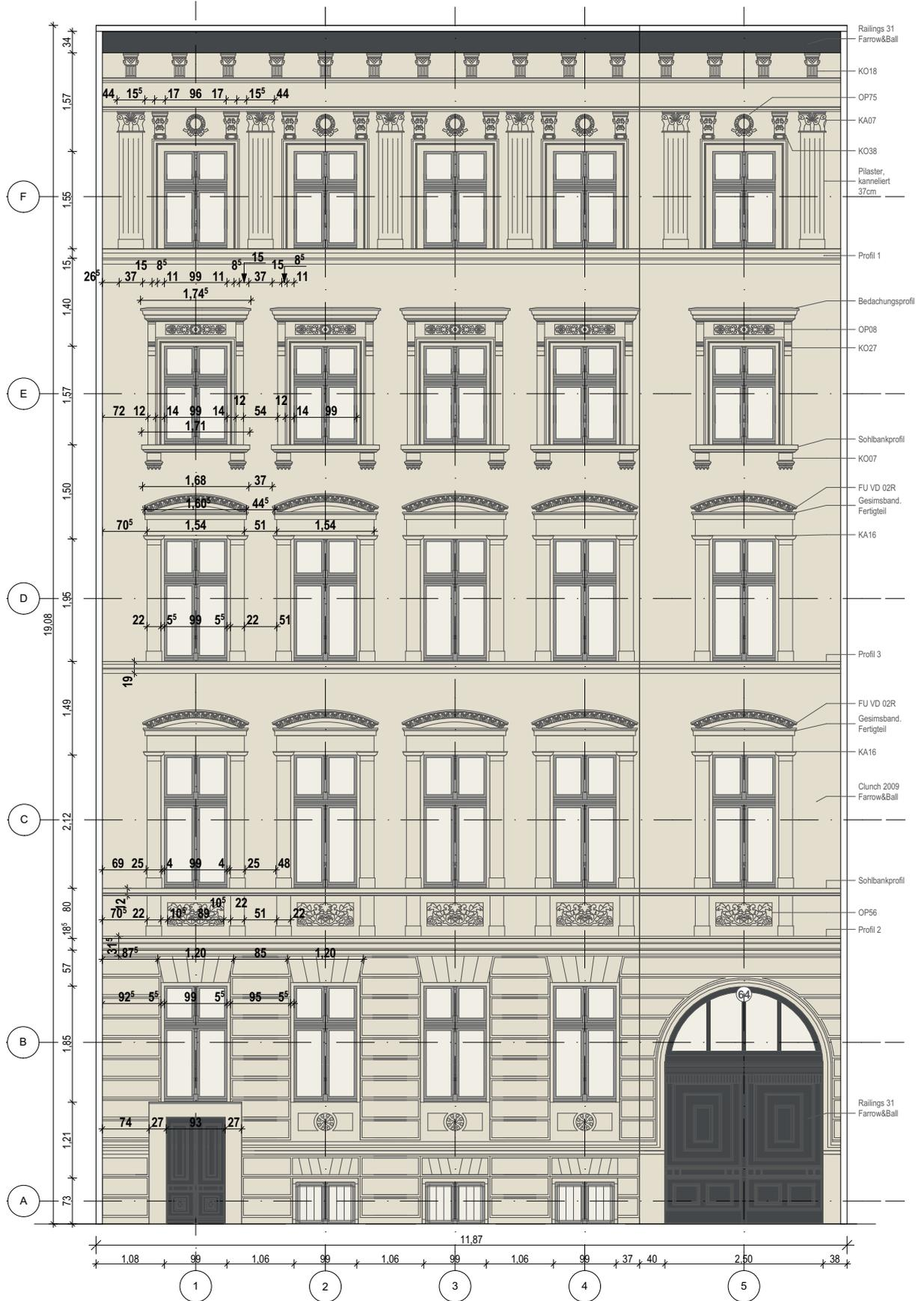
*Detailgetreue Fassadenansicht nach maßstäblicher Einarbeitung von Stuckelementen der Stuckelemente.*
