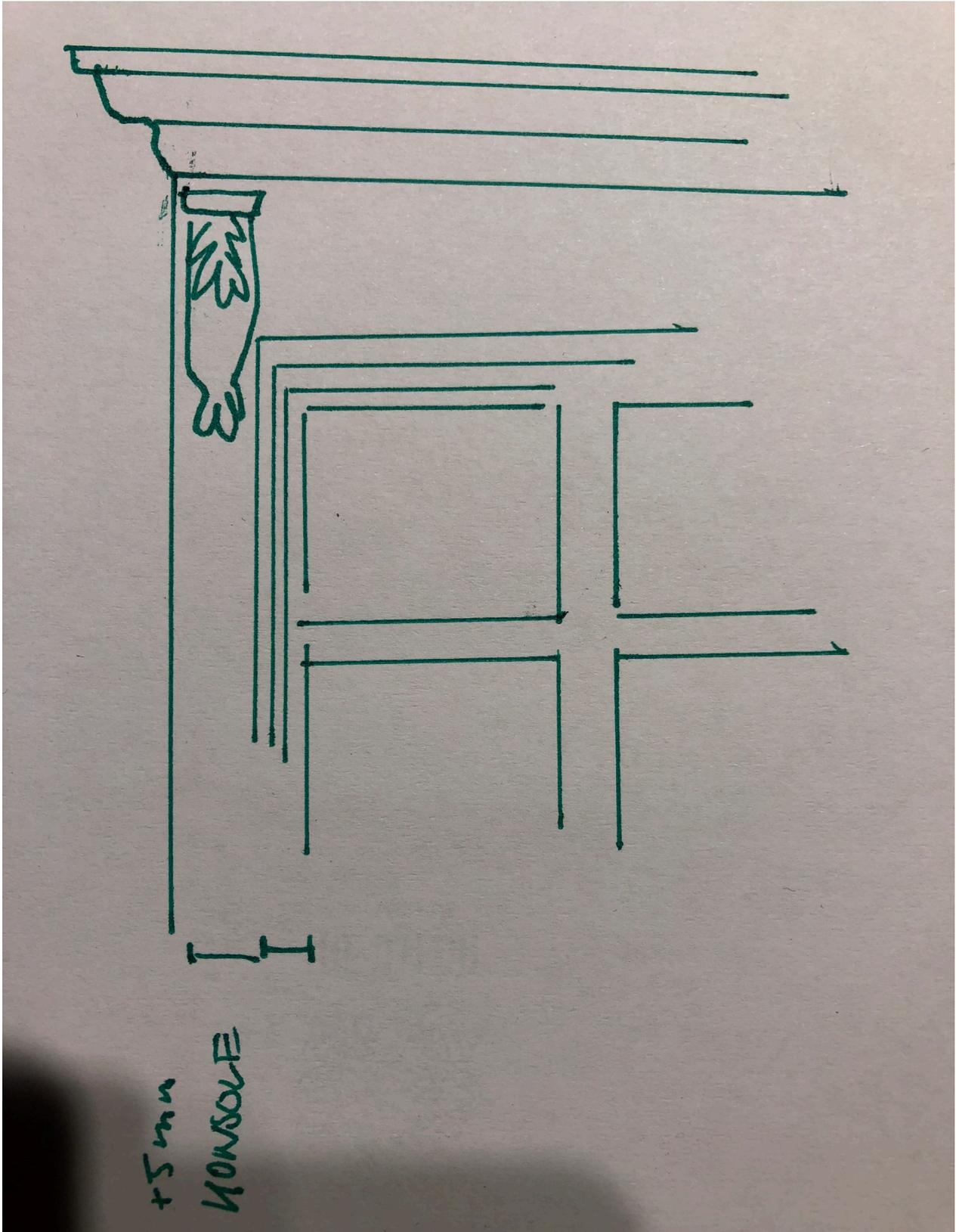
Ausarbeitungsdetails für die Zeichnungserstellung durch den Architekten für Faschenbreite, Konsolenplatzierung, Klärung der historisch notwendigen Profilfolgen und der daraus resultierenden Verdachungsbreite.
